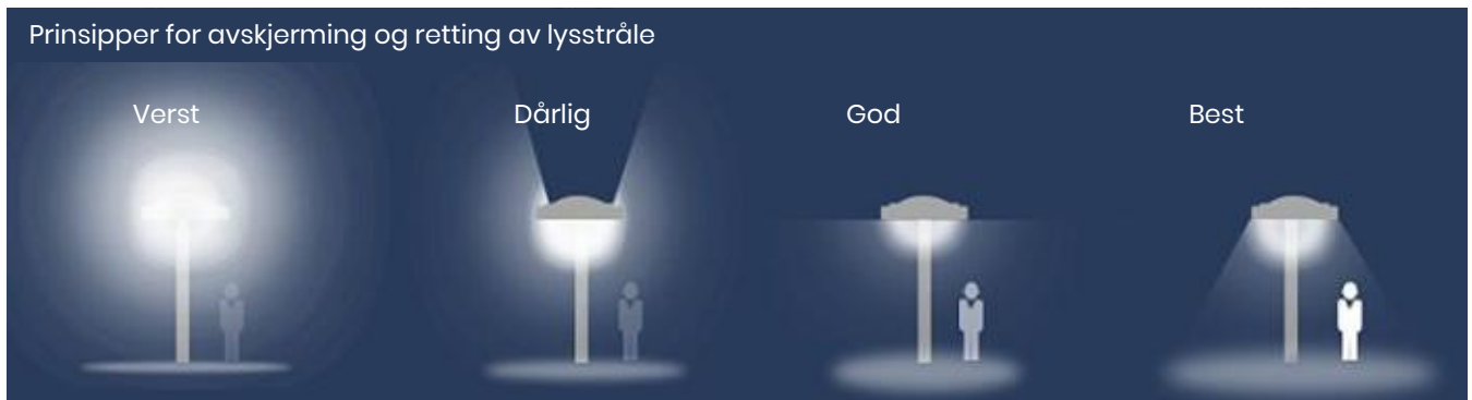
Figur 5. Prinsipper for å redusere strølyst ved avskjerming av lyskilde og bruk av rettet lys.
